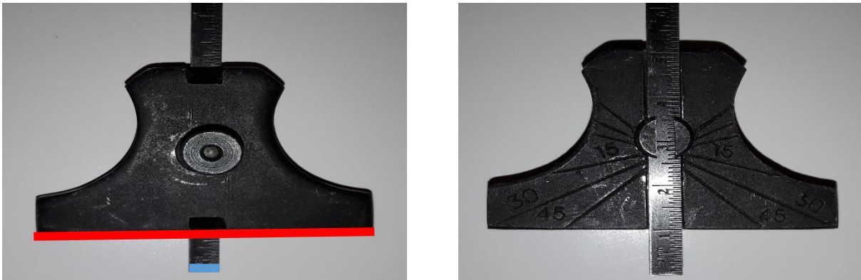
Abbildung 14 und 15: Darstellung Handstück des Tiefenlehremessgerätes für die Ausmessung der Orbita.
